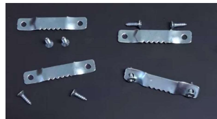
Fixação com ganchos com dente de serra e parafuso
